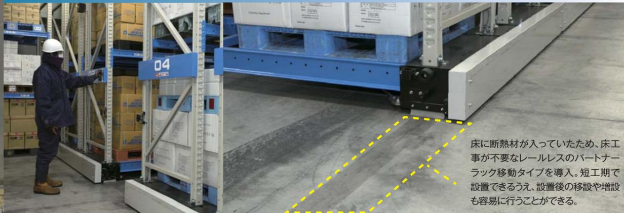
床に断熱材が入っていたため、床工事が不要なレールレスのパートナーラック移動タイプを導入。短工期で設置できるうえ、設置後の移設や増設も容易に行うことができる。
