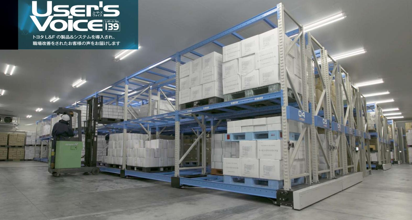
▼ 冷凍庫にレールレスのパートナーラック移動タイプを導入
